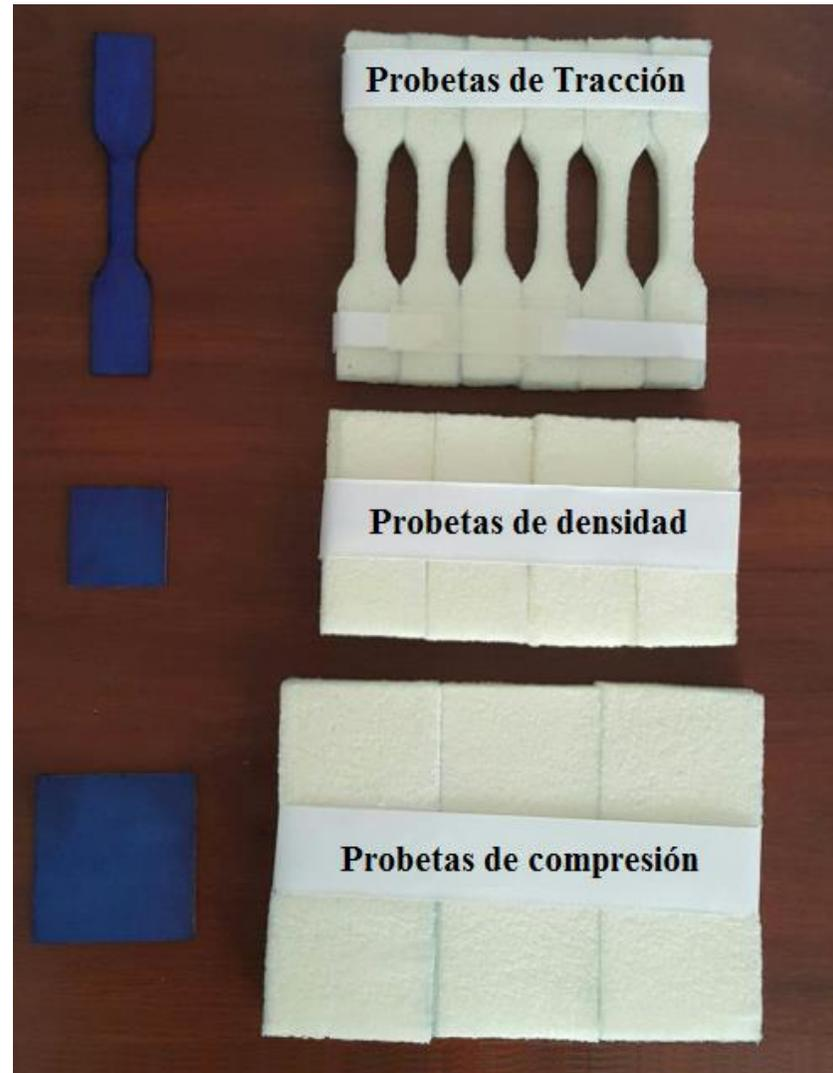
*Figura 24.* Probetas de espuma de poliuretano de alta densidad para ensayos mecánicos. Autor, 2018.
