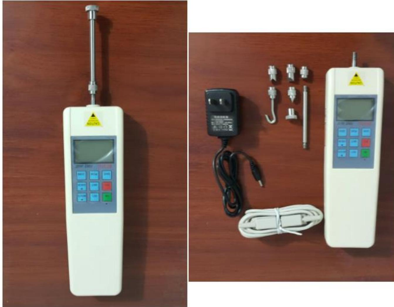
*Figura 17.* Medidor digital de fuerza de empuje, modelo HF-200 con accesorios (derecha) y armado para medir la fuerza de empuje (izquierda). Autor, 2018.
