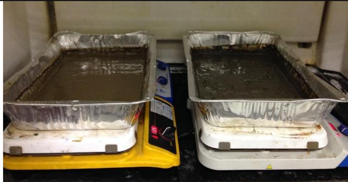
**Foto 6.** Secado de los lodos en la estufa a 105°C
