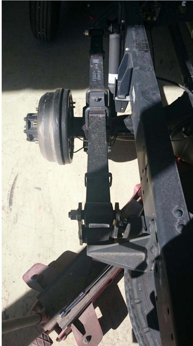
Figura 14. Ballesta trasera camión NLR (vista lateral).
