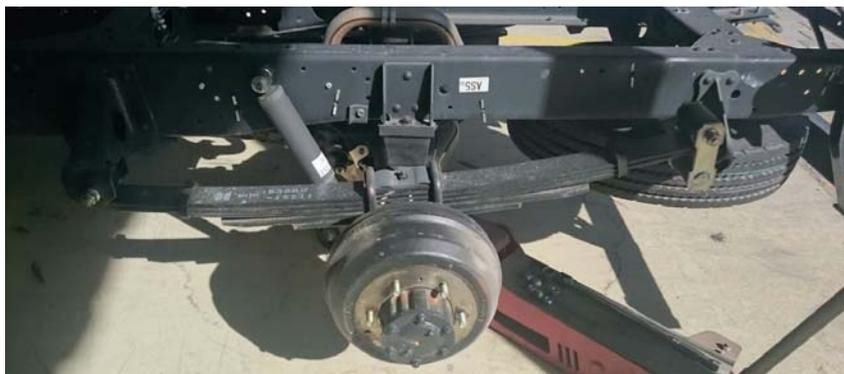
Figura 13. Ballesta trasera camión NLR (vista frontal).
