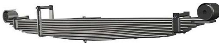
*Figura 7.* Ballesta de acción lineal. Obtenido de (RNA, 2013).
