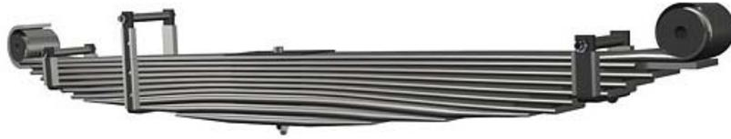
*Figura 5.* Ballesta de acción progresiva. Obtenido de (RNA, 2013).
