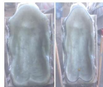
**Figura 6.** Mock-up del asiento recubierto con resina poliéster y fibra natural de cabuya
