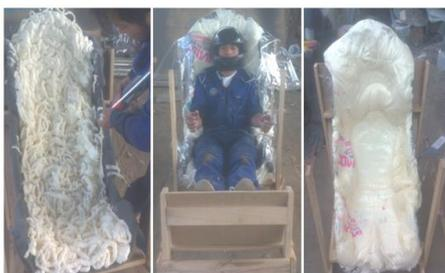
**Figura 4.** Manufactura del mock-up del asiento en espuma de poliuretano
