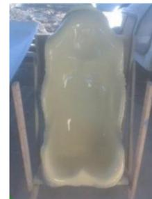
**Figura 5.** Mock-up del asiento recubierto con gel antiadherente
