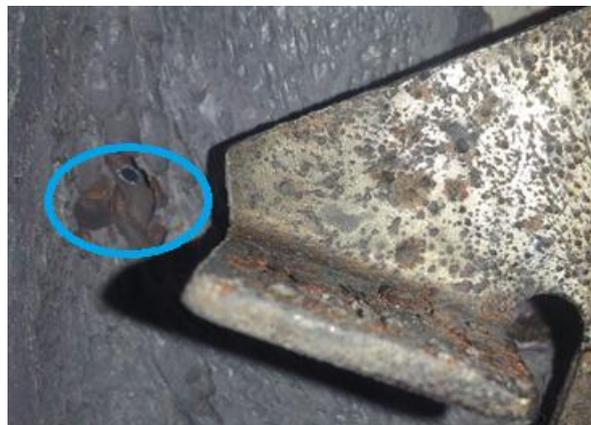
*Figura 3. Perforación provocada por erosión de la voluta.*
