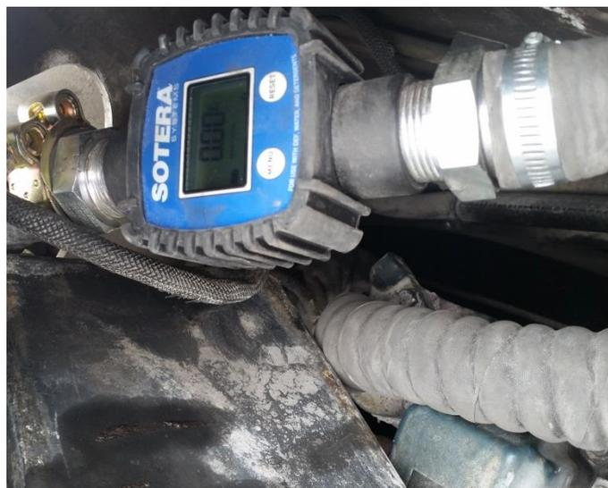
Figura 15. Instalación de flujometro en serie sobre sistema de refrigeración.
