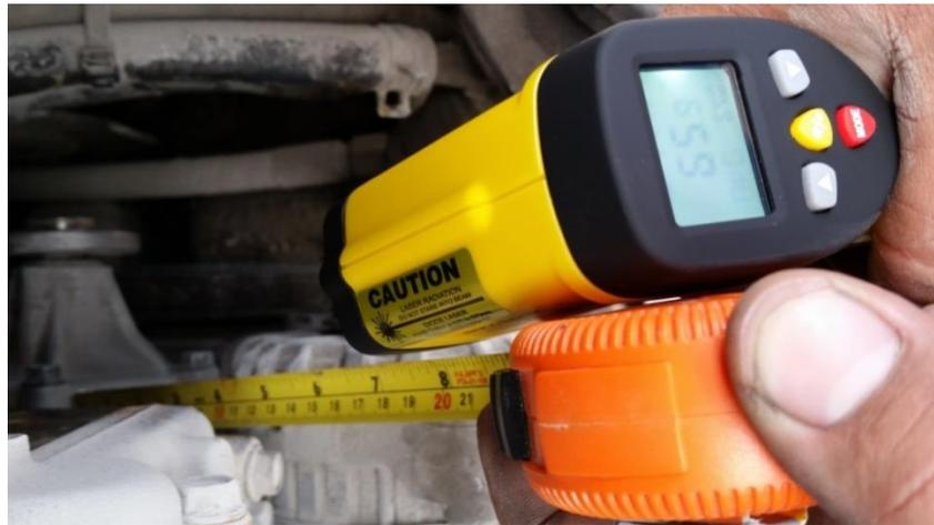
Figura 48. Termómetro laser.
