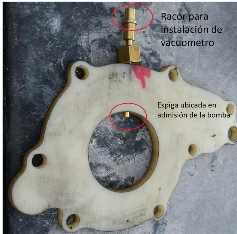
Figura 14. Herramienta especial para instalación de Vacuometro en admisión de la bomba centrifuga
