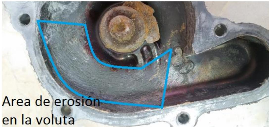
*Figura 2. Área sobre la cual se presenta erosión en la voluta de la bomba centrifuga.*
