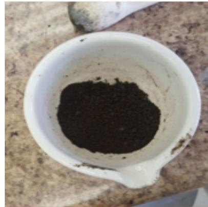
**Foto 10.** Digestión de lodos para análisis de Nitrógeno Kjeldahl.
