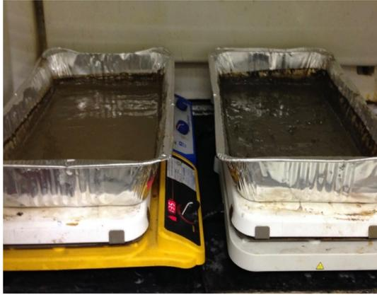
**Foto 7.** Secado térmico en la estufa del lodo espeso (Lodo 2).
