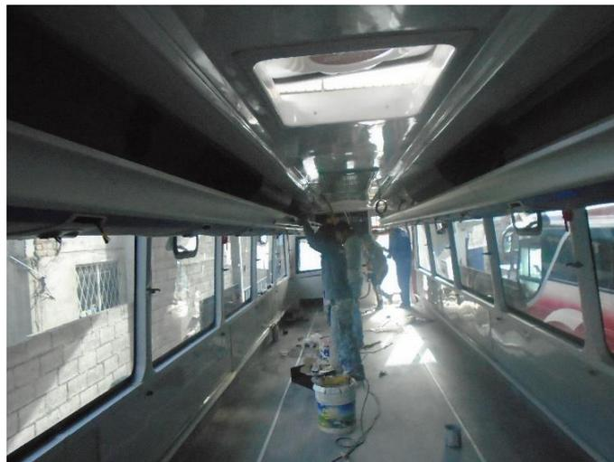
**Figura 17.** Parte interior forrada con la capa de fibra de vidrio Fuente: Autor
