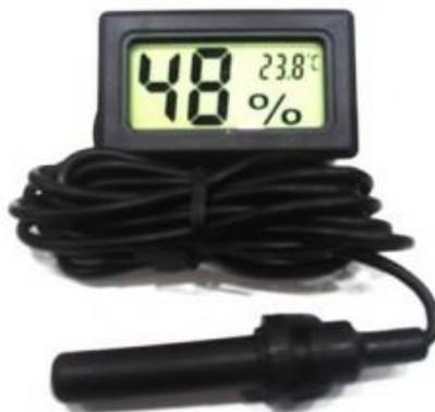
**Figura 25.** Termo higrómetro digital
