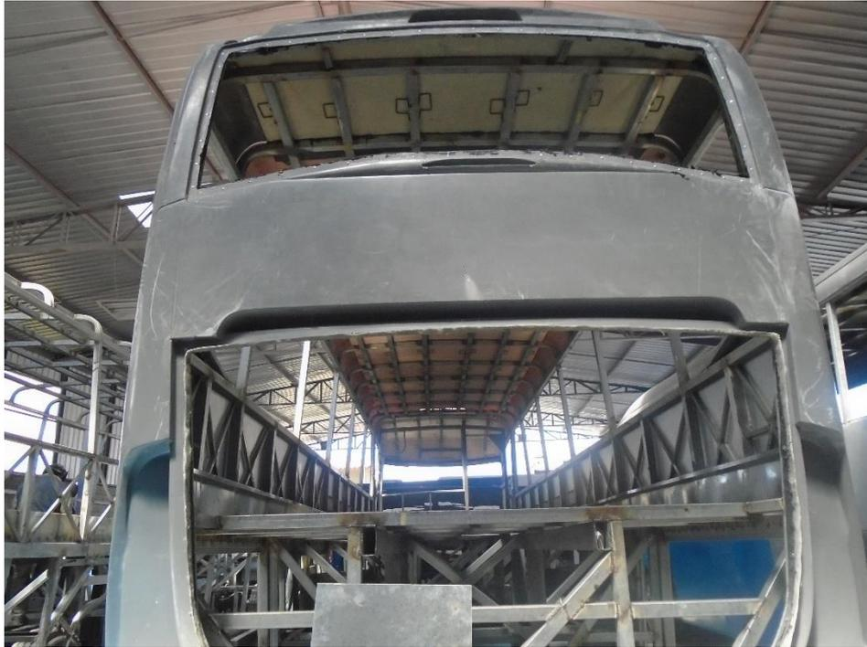
**Figura 20.** Pared posterior de la carrocería sin pintura. Fuente: Autor
