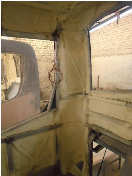
**Figura 64.** Espuma de poliuretano pared posterior
