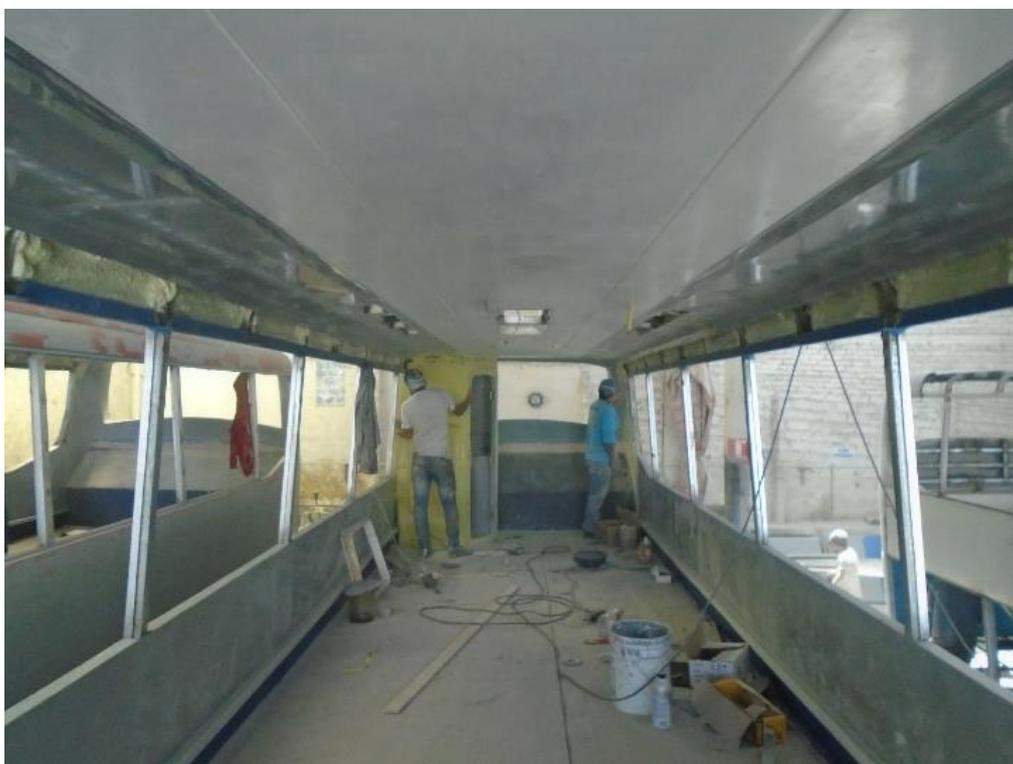
**Figura 65.** Recubrimiento de carrocería con capa de fibra
