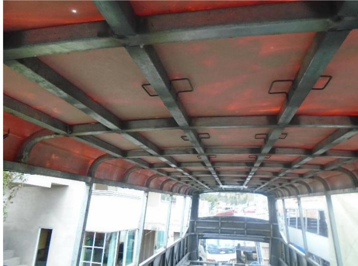
*Figura 22.* Techo colocado en la carrocería Fuente: Autor
