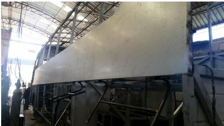
**Figura 15.** Parte exterior de la pared de la carrocería Fuente: Autor
