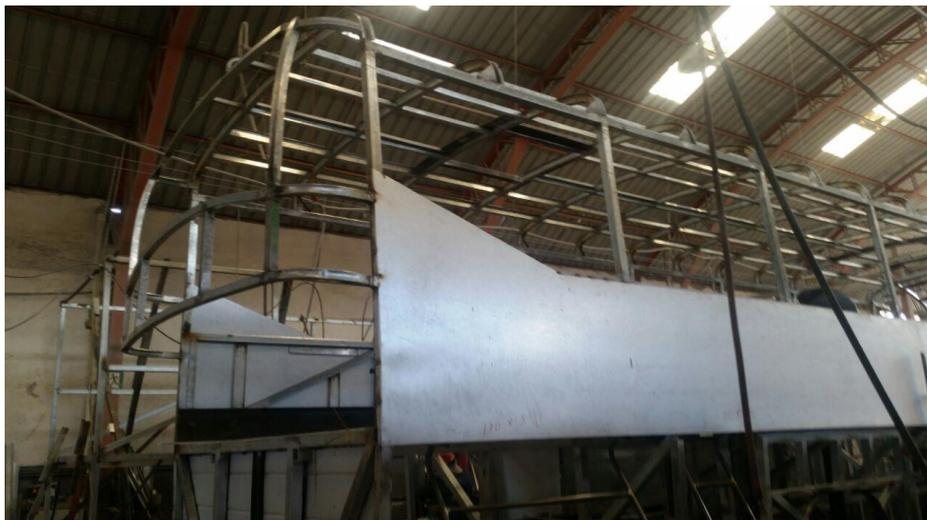
*Figura 18.* Parte posterior de la carrocería Fuente: Autor
