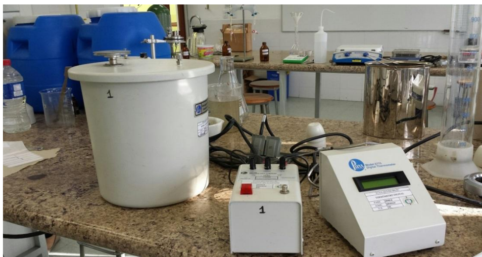
Imagen 3. Equipo para la determinación del poder calórico
