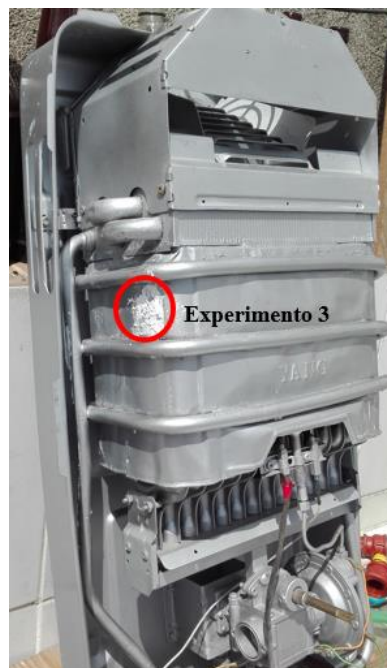
Figura 27. Ubicación de celda en el experimento 3, en la parte interna del calentador de agua.
