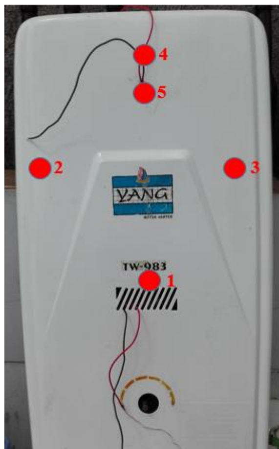
Figura 17. Puntos de interés donde se tomaron mediciones de temperatura preliminares.
