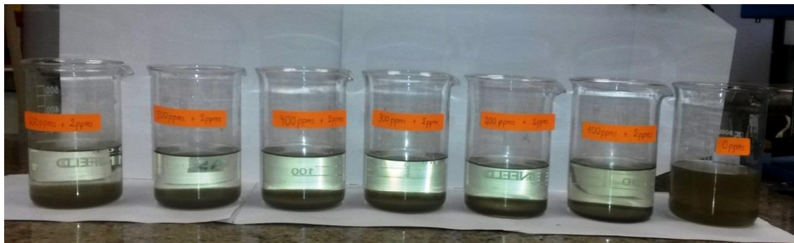
Figura 28: Agua clarificada con PAC y Polímero Aniónico con sedimentación de sólidos Autor: Luna, 2016
