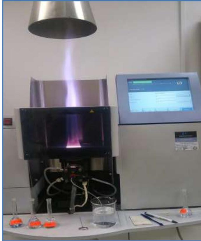
**Figura 3 Espectrofotómetro Perkin Elmer Analyst 200**
