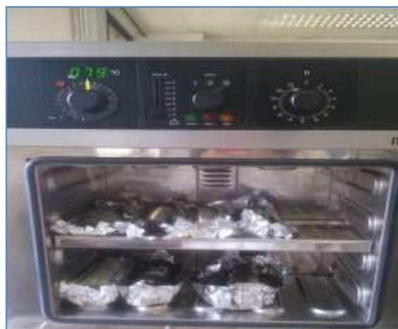
**Figura 12 Secado en estufa de sedimentos y suelos**
