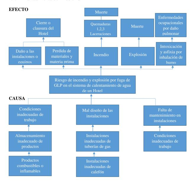
Existe un riesgo de incendio y explosión en el área de calentamiento de agua por manejo de tanques de Gas Licuado de Petróleo por las siguientes causas:
