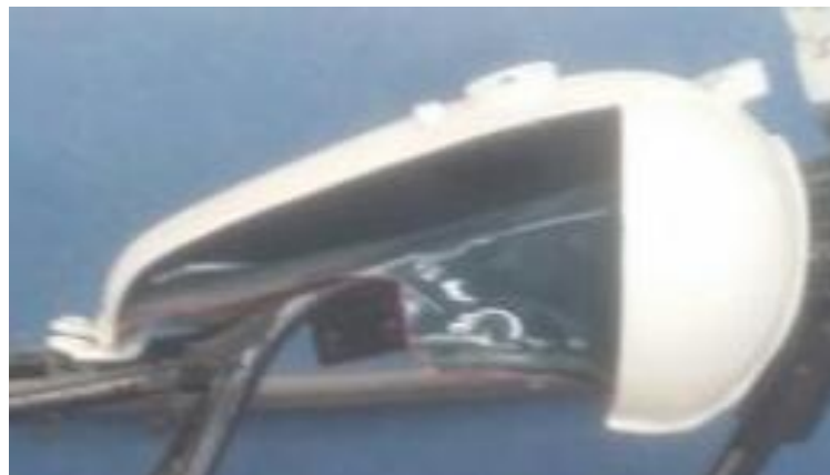
Figura 36. Depósito de combustible seccionado
