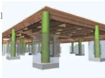
CIMENTACION MEDIANTE PILAS
