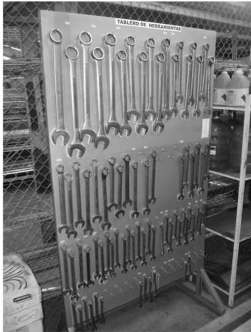
**Figura 7.4.** Percha para el almacenamiento de las llaves en el área de bodega.
