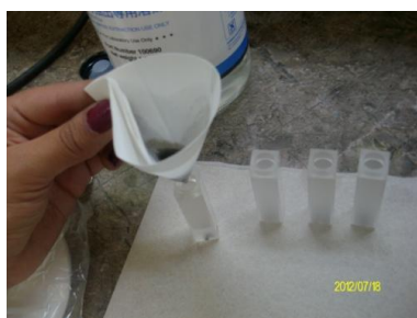
Fotografía No. 4: Filtración de la mezcla para medición. Fernanda Chávez, 2012.
