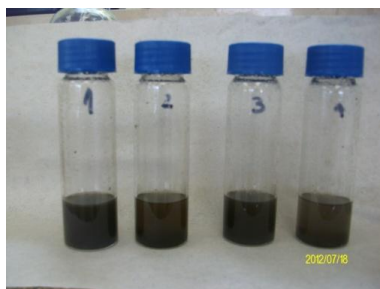
Fotografía No.3: Mezcla para medición de TPH con reactivo S-316. Fernanda Chávez, 2012.
