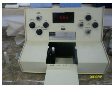
Fotografía No. 5: Medición de TPH en espectrofotómetro de absorción atómica. Fernanda Chávez, 2012.
