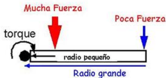
Figura 2. Fuerzas aplicadas para determinar el torque,
