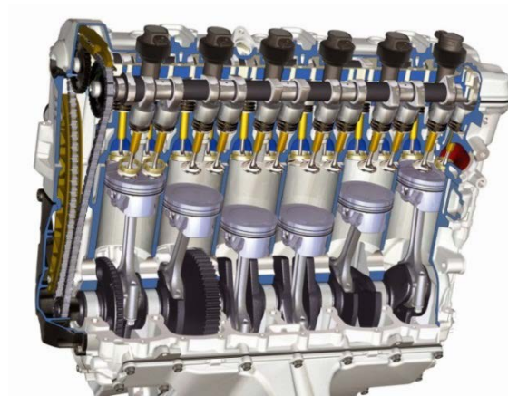
Figura 3, Motor disposición en línea,
