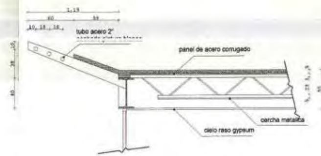
DETALLE 3 REMATE DE CUBIERTA ESCALA 1:20
