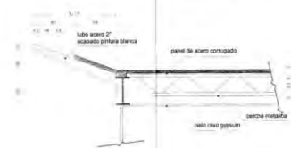
DETALLE 6 REMATE DE CUBIERTA ESCALA: 1/20
