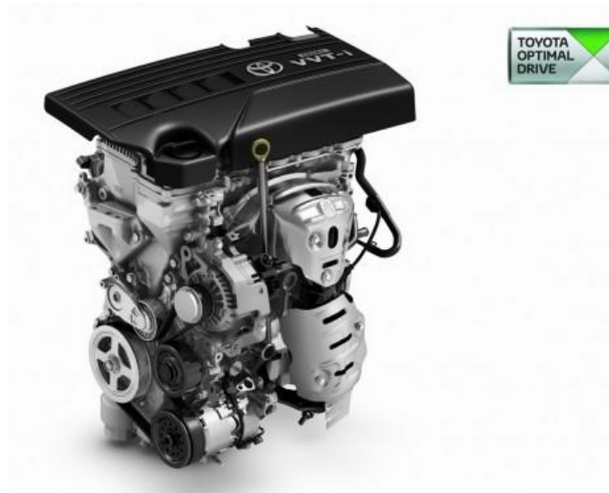
Figura 11. Motor (2TR-FE) con sistema VVT-i
