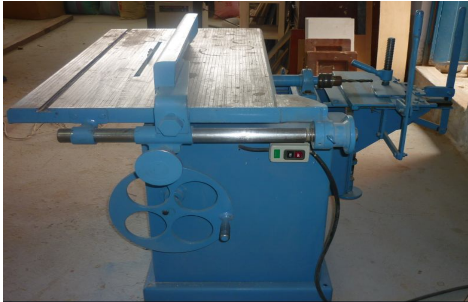
Figura 8. Sierra circular y huequeadora
