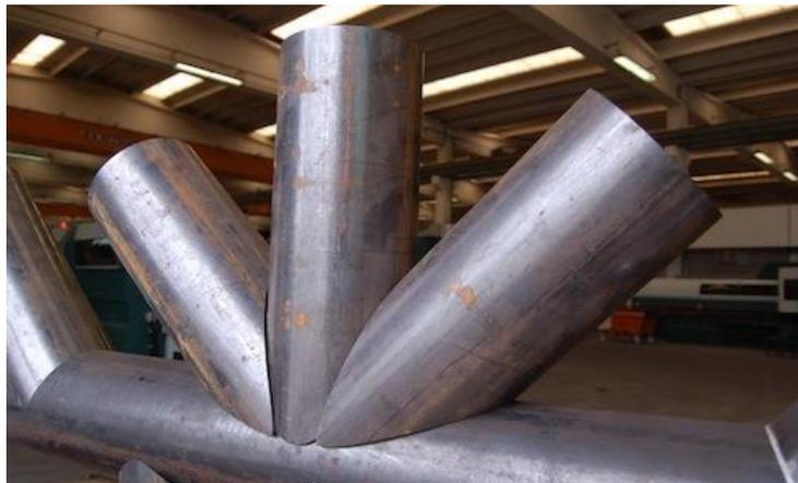
Figura 9: Unión de tubo circular
