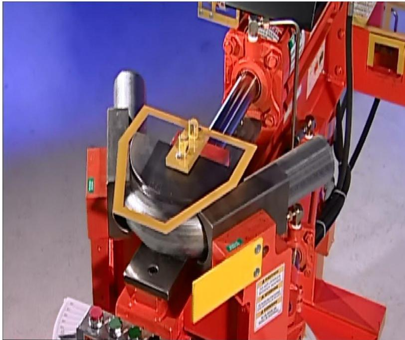
Figura 6: Dobladora de tubo por empuje hidráulico eléctrico.
