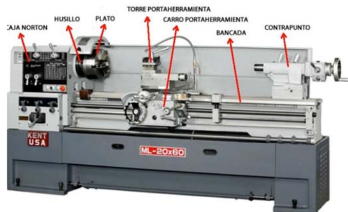
Figura 9. Partes y elementos de un torno convencional paralelo.
