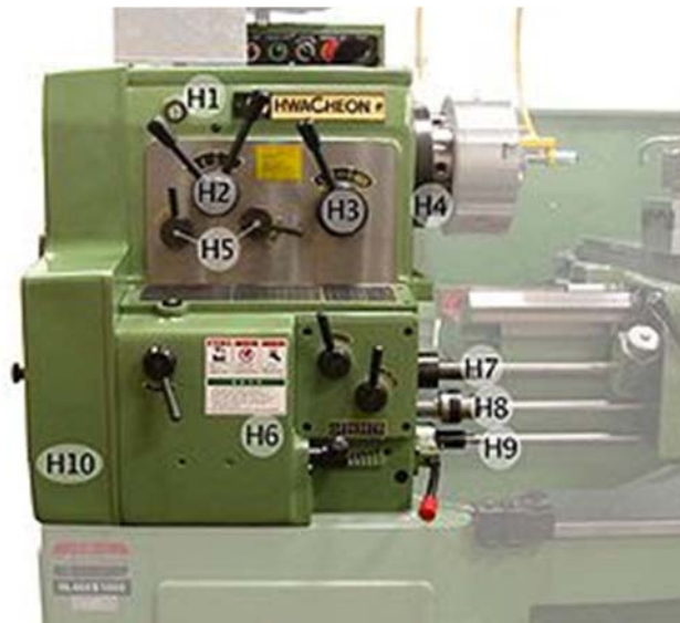
Figura 11. Distribución de palancas en caja de torno paralelo.
