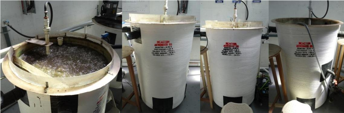
Fotografía B- 13: Reactores aireados de la planta piloto
