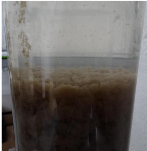
**Fotografía B- 12: Interfase de sedimentación de la fase 3**
