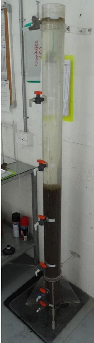
**Fotografía B- 11: Prueba de sedimentación en columna fase 3**
