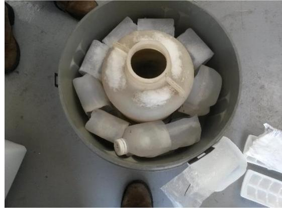
**Fotografía B- 3: botella del muestreador refrigerada**
