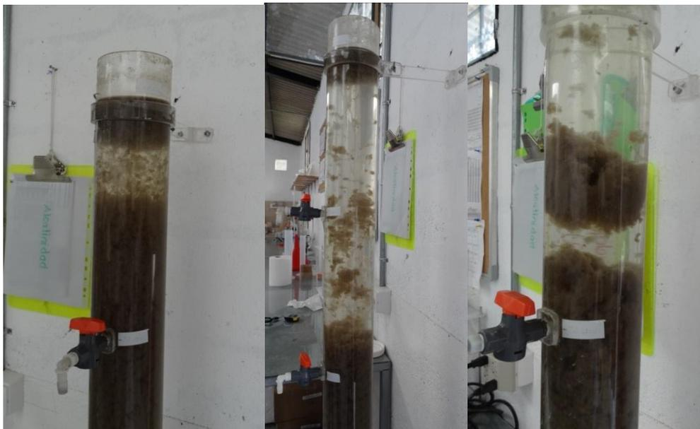
**Figura 9, Figura 10 y Figura 11: Levantamiento de lodos.**
