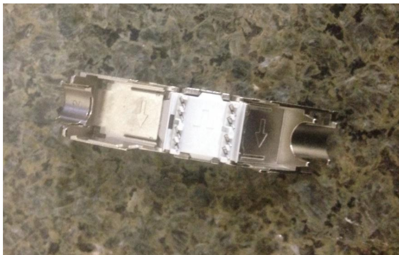
Figura No. 27: Roseta hembra RJ-45 cat6a blindado CEMCP. Elaborado por: Bryan Córdova
