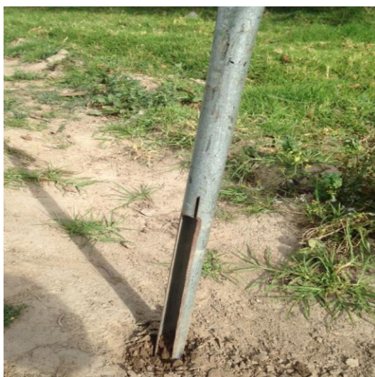
Toma de muestra con barreno cilíndrico
