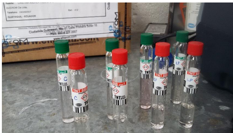
Fuente: (Carcelén Arcos, 2015) Tubos post tratamiento de digestión para NTK.
