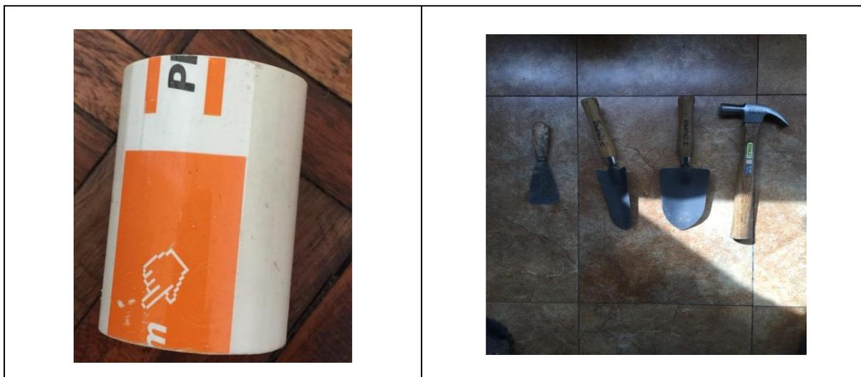
1. Tubo PVC de 2 " de diámetro y 7 cm de altura y materiales para toma de muestras
