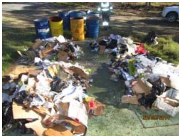
FOTOGRAFÍA N o 6. Método de cuarteo
