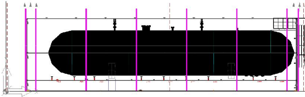
Figura 34. Sistema de Rociadores
