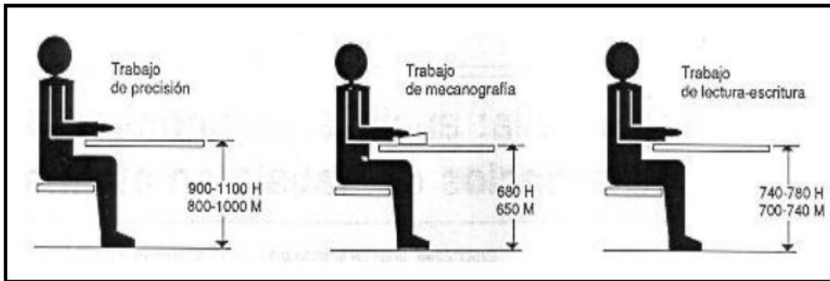
Figura 5. Altura del plano de trabajo para puestos de trabajo sentado (en mm)
