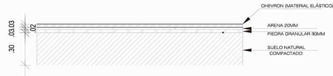
2 DETALLE DE PISO PISTA ATLÉTICA Escala 1:10
