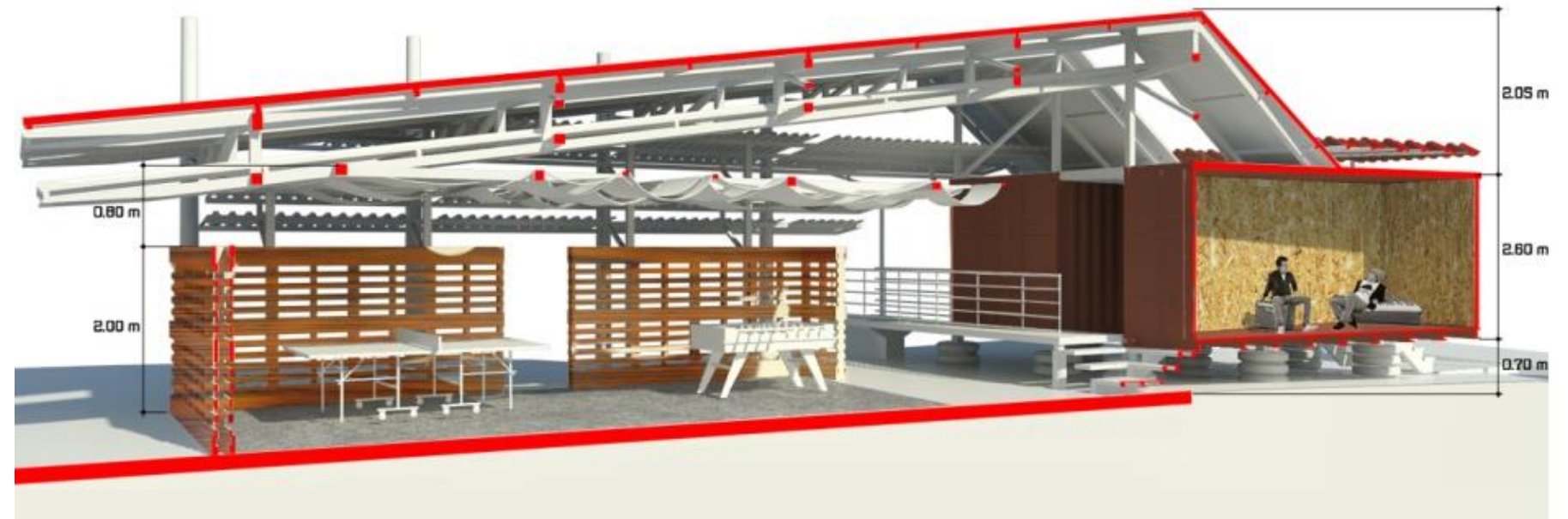
Imagen 108. Corte módulo base
