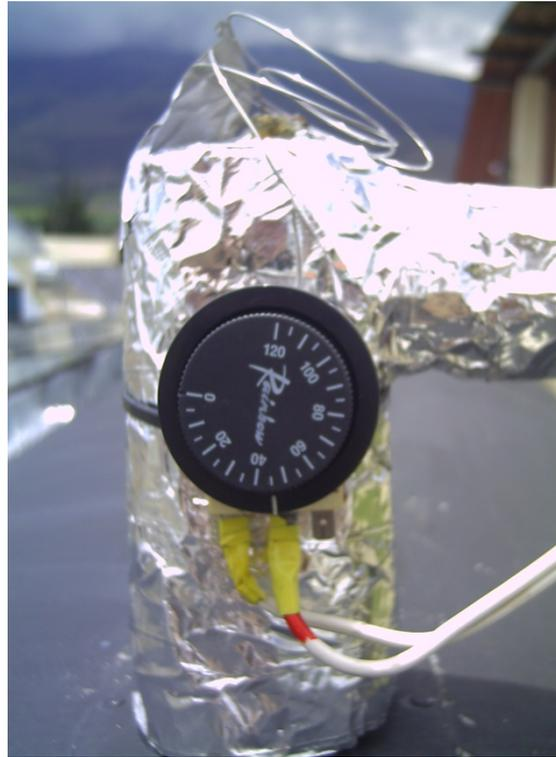
Figura 25. Termostato utilizado, tiene un diferencial de temperatura de 10°C
