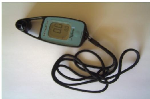
Figura 31. Anemómetro (medidor de la velocidad del viento)
