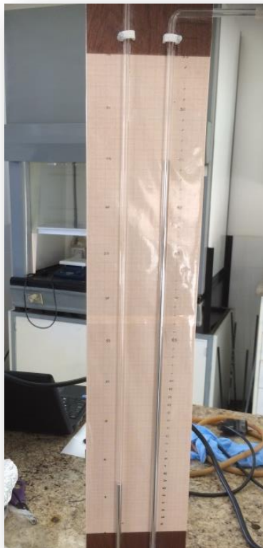
Figura 2.0. Manómetro en “U”.
