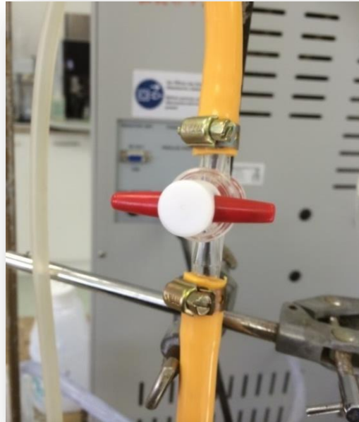
Figura 3.0. Válvula de venteo.
