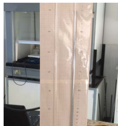
Figura 1.7. Manómetro en “U”.
