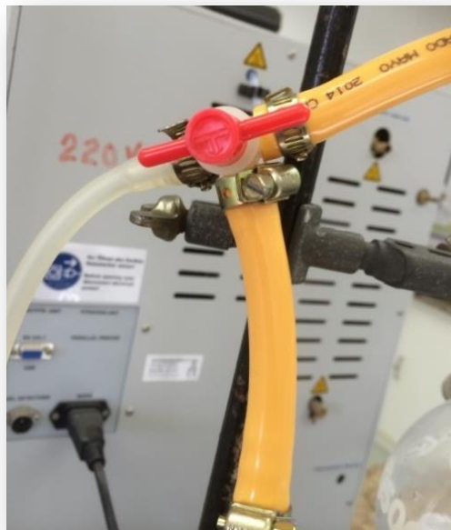
Figura 2.9. Posición correcta para válvula de 3 vías.
