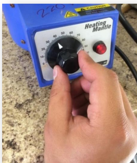
Figura 3.3. Inicio del calentamiento a una potencia de 40.
