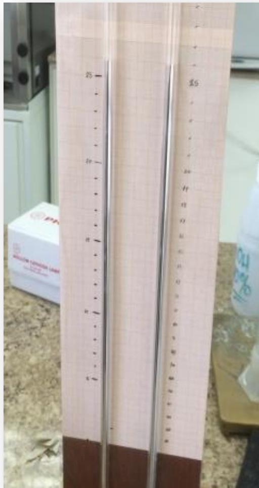
Figura 2.4. Nivel inicial en las columnas de mercurio 26 cm.
