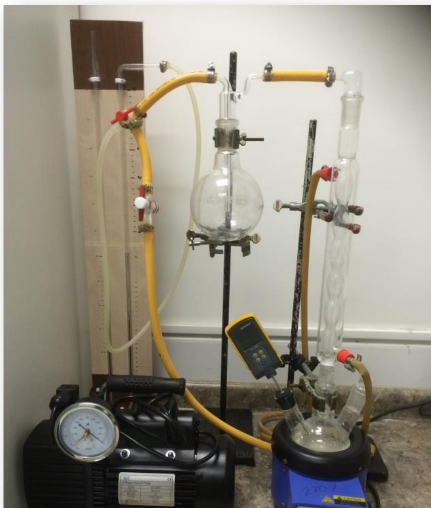
Figura 2.3. Sistema de vacío ensamblado.
