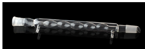
Figura 1.5. Refrigerante de bolas esmerilado 24/40.
