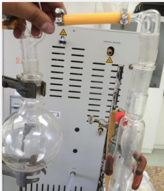
Figura 3.1. Adición de grasas en conexiones.
