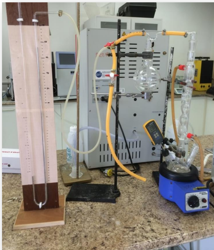
Figura 3.4. Sistema de vacío en funcionamiento.
