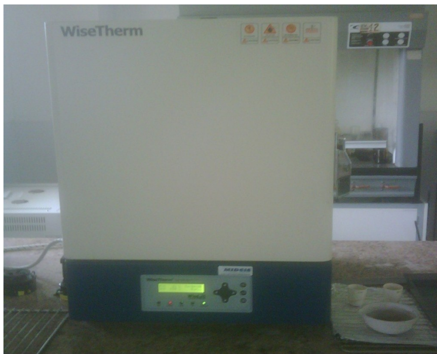
Figura 27: Mufla donde se determina el porcentaje de carbono después de la incineración de materia orgánica. Fuente: (Arteaga, 2014).
