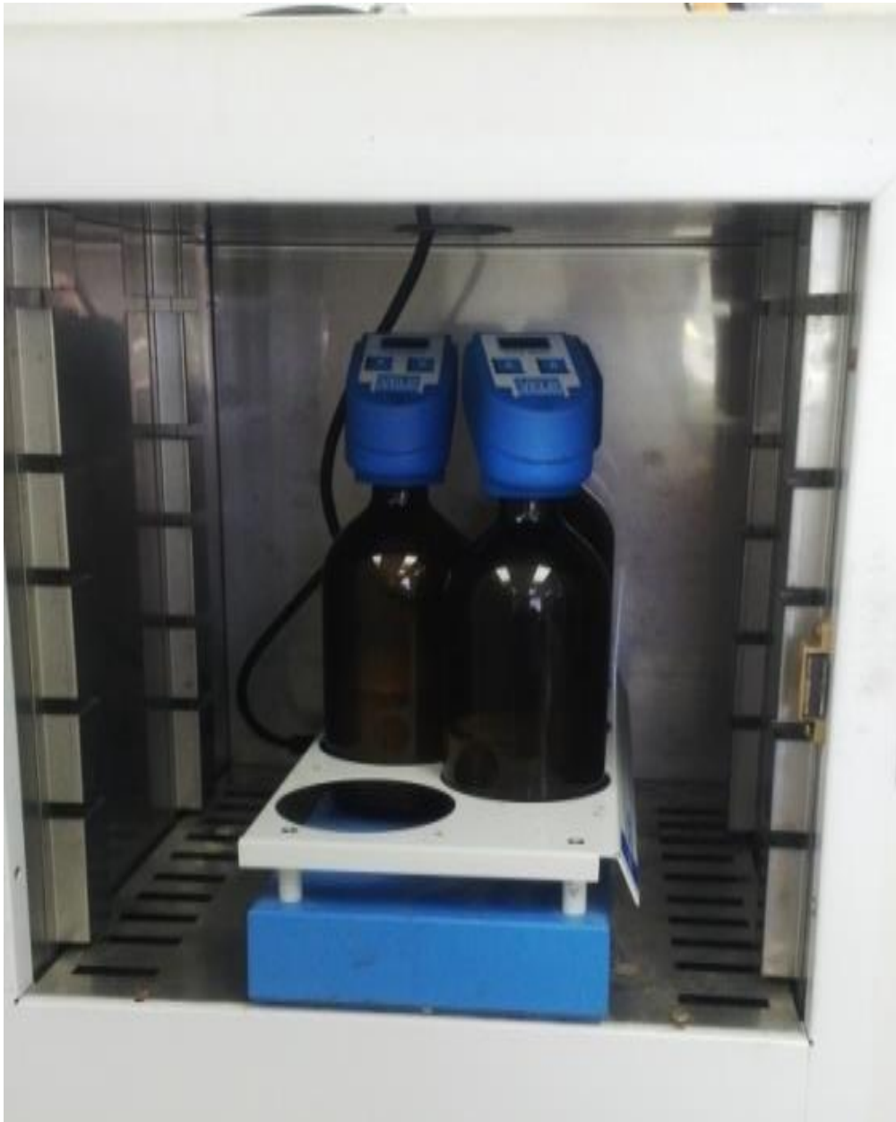
F6: Incubadora, análisis de muestras de agua, DBO5.
