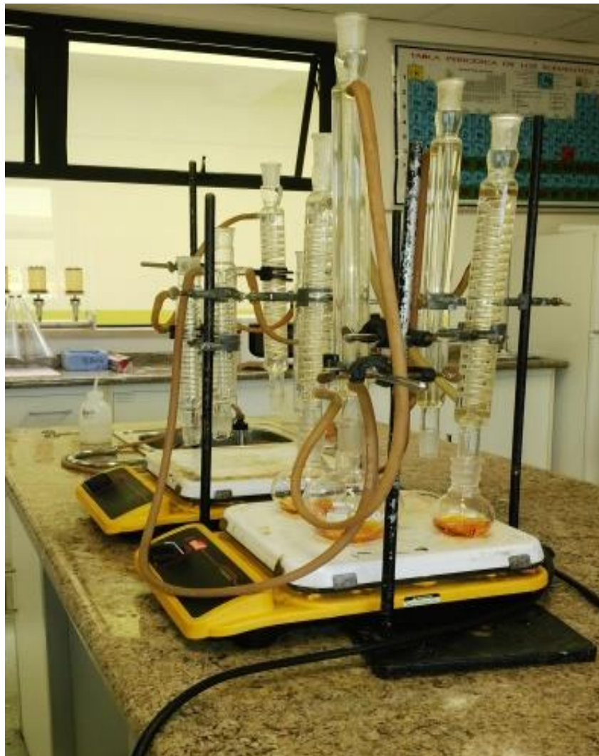
F: 7 Equipo para la determinación de DQO por reflujo abierto.
