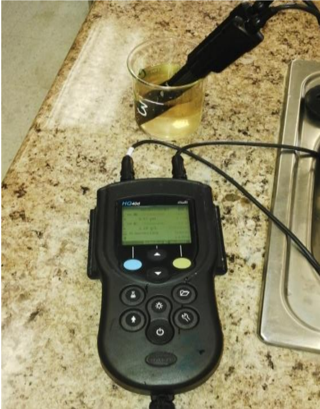
F4: Medidor Multiparámetros (Medición de pH, Conductividad).
