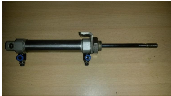
Figura 4. Cilindro de doble efecto
