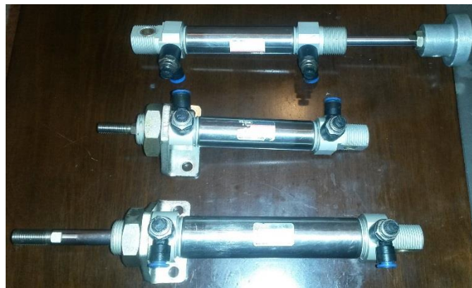
Figura 4. Cilindro de doble efecto
