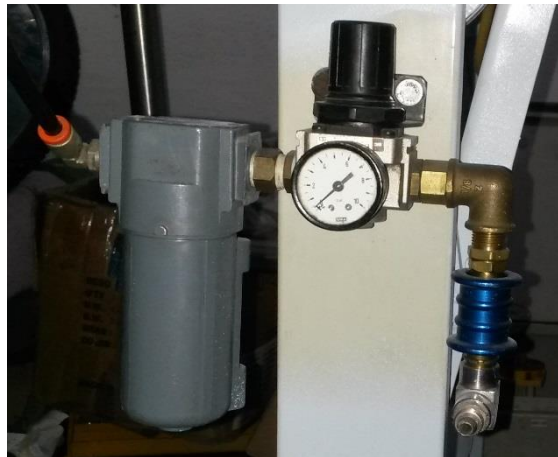
Figura 2. Unidad de mantenimiento SMC
