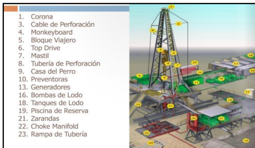
Figura 2. Esquema de un equipo de perforación
