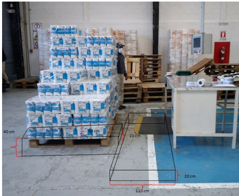
Gráfico N° 11. Dimensiones plataforma de trabajo
