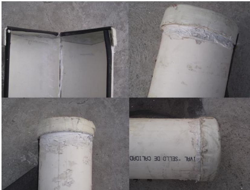
Figura 10. Impermeabilización de las tapas
