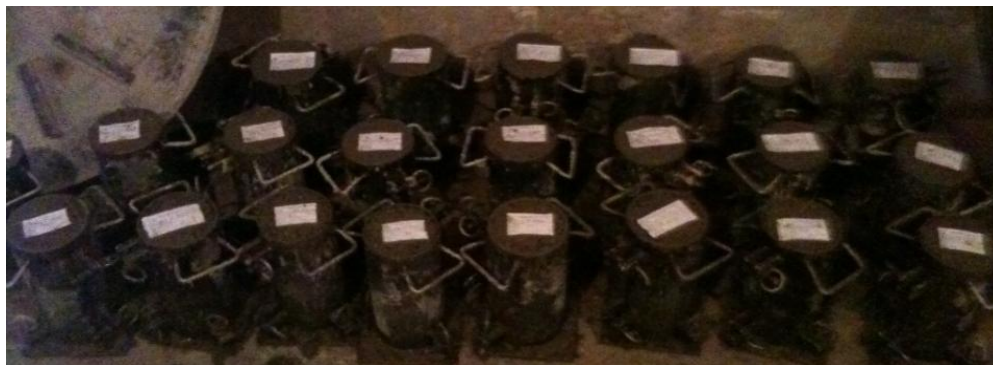
Figura 22. Cilindros de hormigón
