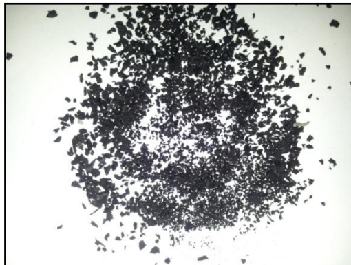
Fotografía No. 5 Material malla 20 equivalente a 0,841 mm
