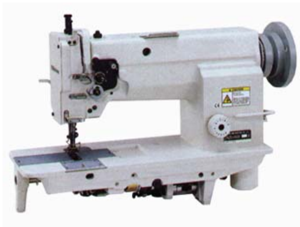
FIGURA 23: MÁQUINA DE COSTURA RECTA
