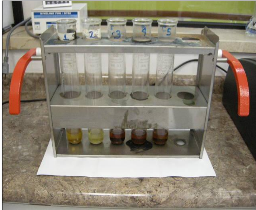
Figura 30: Equipo de digestión INKJEL M.
