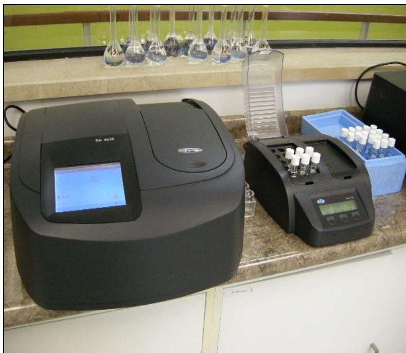
Figura 29: Espectrofotómetro HACH 5000 y digestor.
