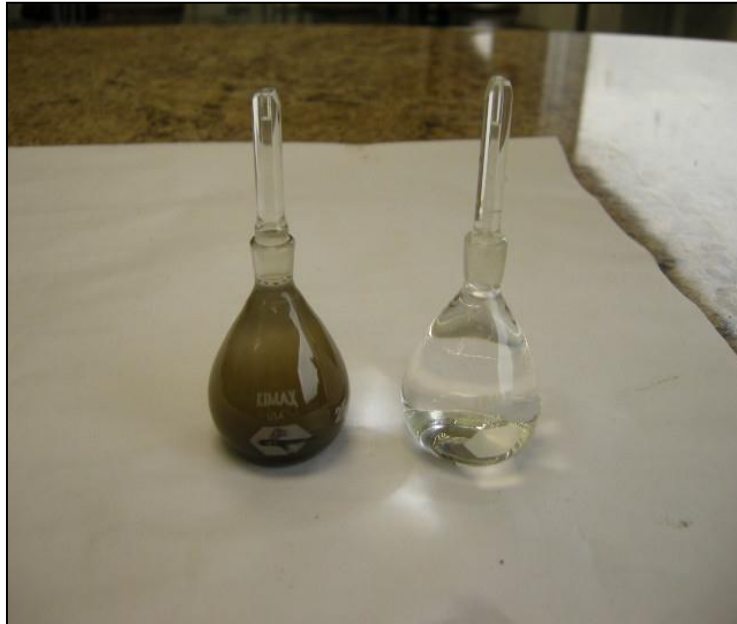
Figura 23: picnómetro de vidrio, (25 mL de capacidad).
