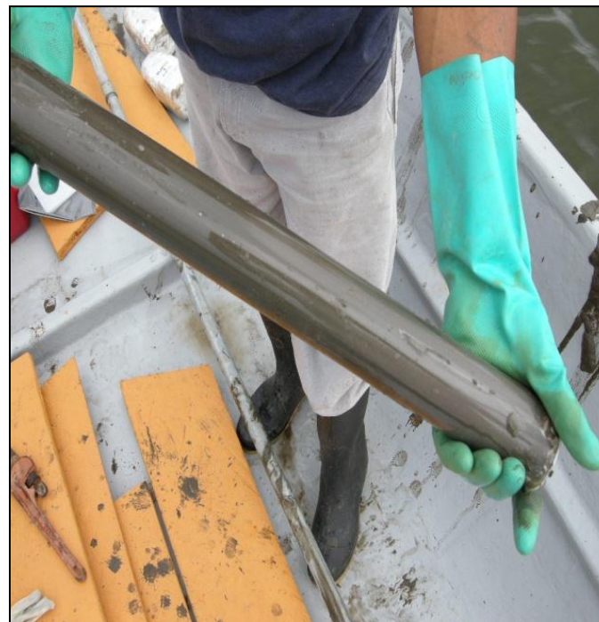
Figura 7: Muestra de sedimento en “cartucho” del nucleador.
