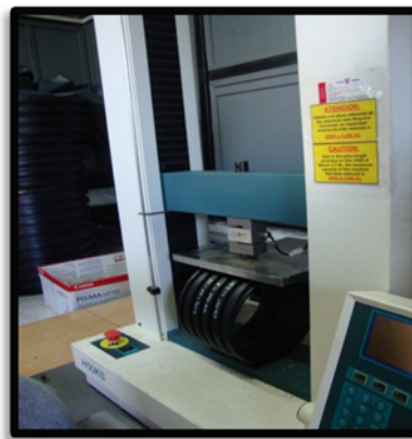
Figura N° 20: Máquina Universal realizando ensayo de Rigidez Anular sobre tubería
