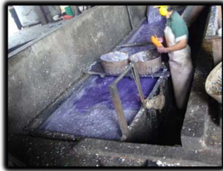
Figura N° 10: Lavado de Polietileno de Alta Densidad Reciclado
