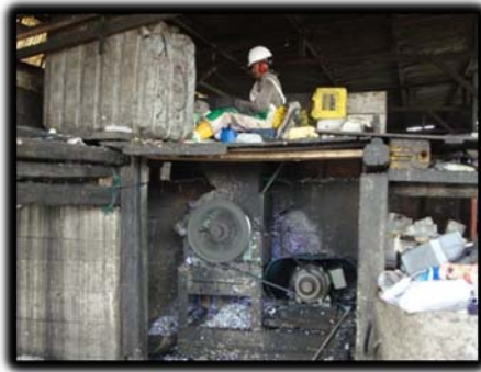
Figura N° 9: Trituradora de Polietileno de Alta Densidad Reciclado.
