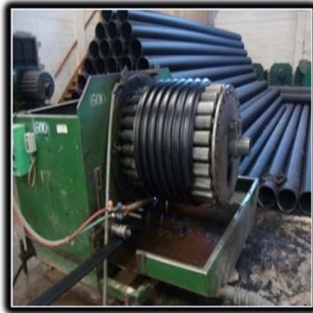
Figura N° 4: Extrusora de Polietileno ensamblando Tubería.
