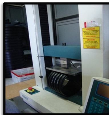
FIGURA 1: MÁQUINA UNIVERSAL REALIZANDO ENSAYO DE RIGIDEZ ANULAR
