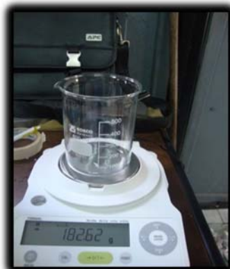
Figura N° 15: Equipos para determinación de la Densidad del Polietileno de Alta Densidad Reciclado.
