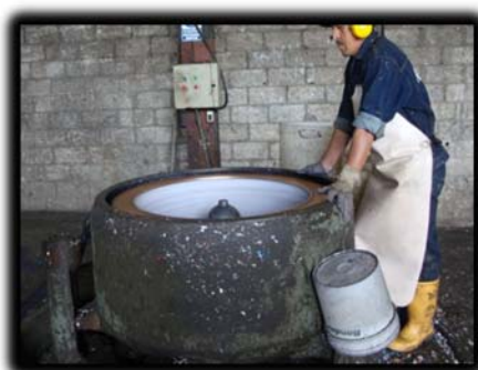
Figura N° 11: Centrifugado de Polietileno de Alta Densidad Reciclado
