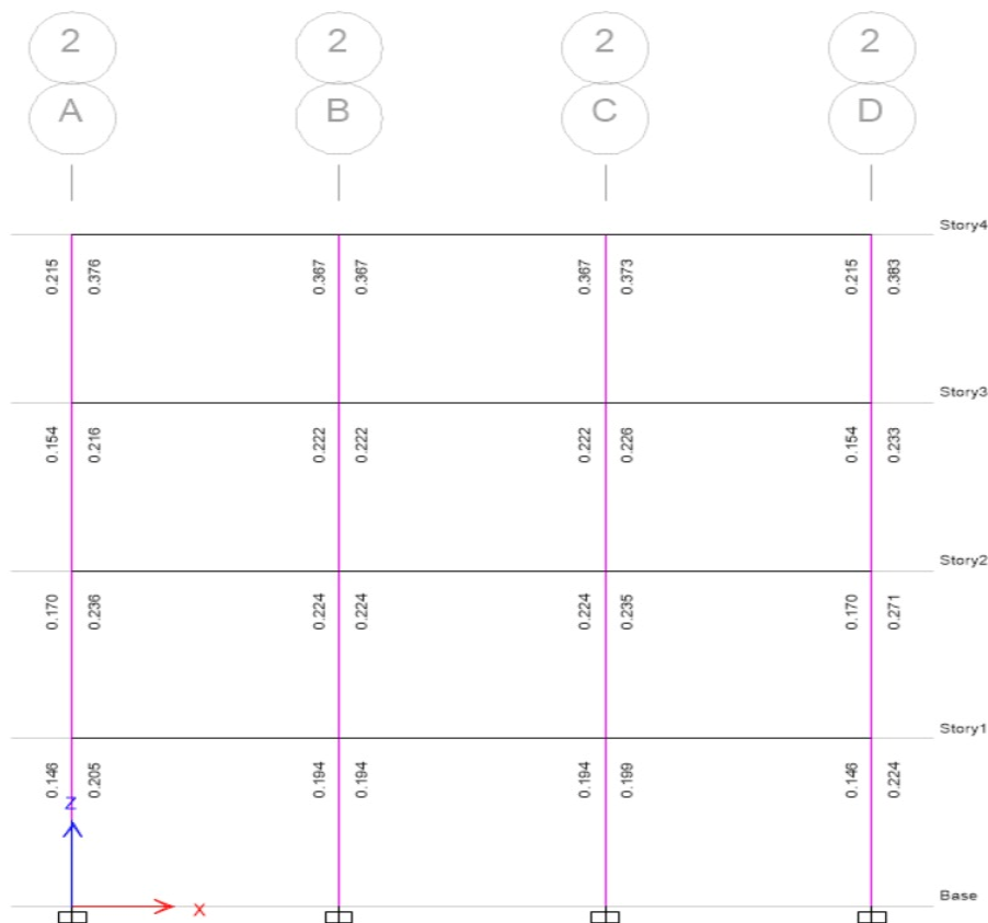
Ilustración 89. Verificación nudos eje crítico
