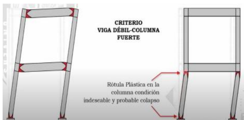
Ilustración 14. Criterio columna fuerte - viga débil
