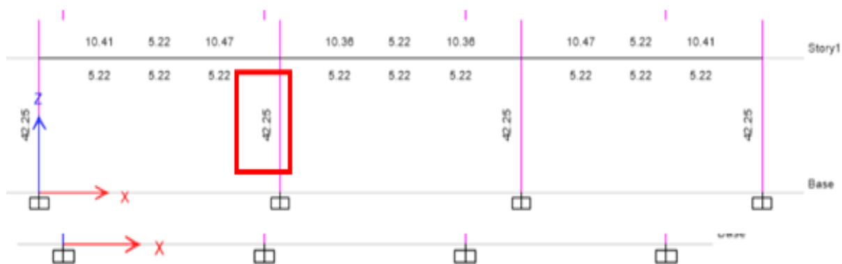
Ilustración 103. Verificación manual de armado en columnas de hormigón armado modelo 2
