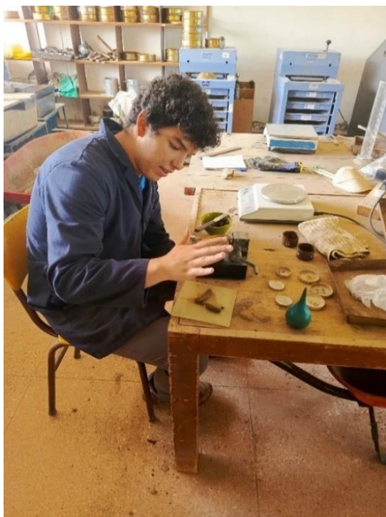
Figura 23 Ensayo de Límite Plástico
