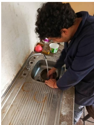
Figura 26 Tamizado por lavado
