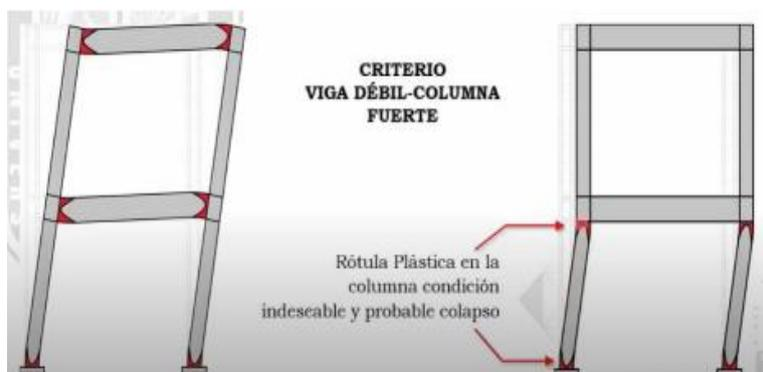
Ilustración 14. Criterio columna fuerte - viga débil
