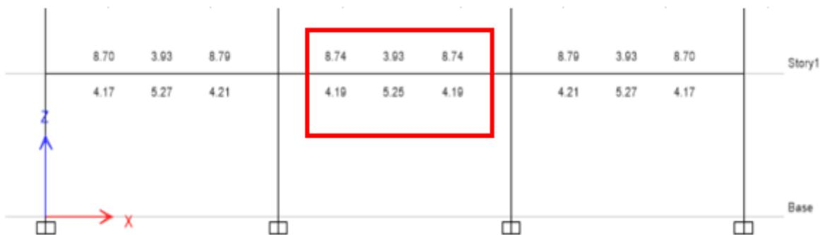
Ilustración 134. Verificación manual de armado en vigas de hormigón modelo 4
