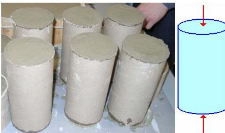
Ilustración 3. Testigos de hormigón
