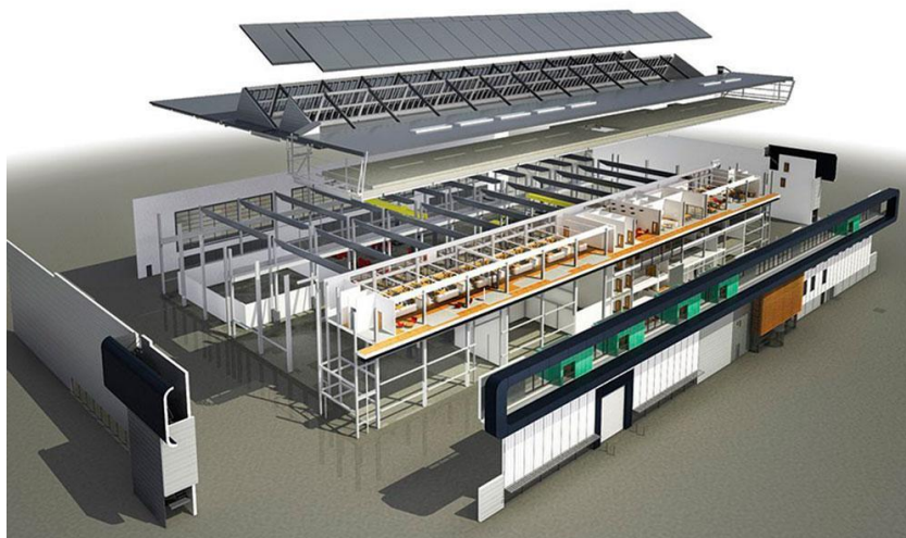
Figura 26. Representación proyecto con metodología BIM
