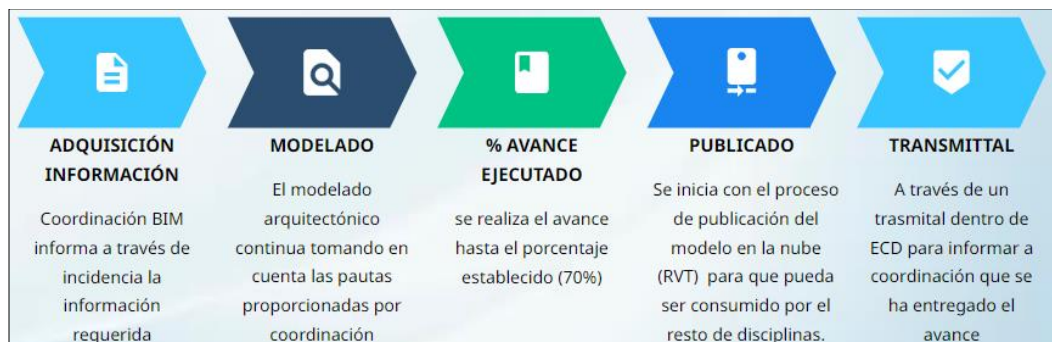
Figura 28. Proceso para intercambio de información con coordinación BIM. Adaptado de: Grupo 5, Industrial BIM.
