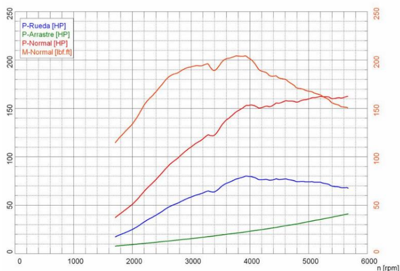
Curva de potencia Haval H2.
